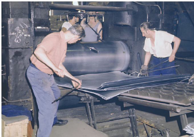
Bild 5.: Herstellung von Zinktafeln im Paketwalzverfahren.
