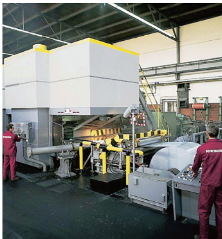
Bild 10.: Am Ende der Walzstraße wird das fertiggewalzte Band zu Großcoils aufgewickelt und zur Abkühlung zwischengelagert (Bild: Rheinzink, Datteln).
